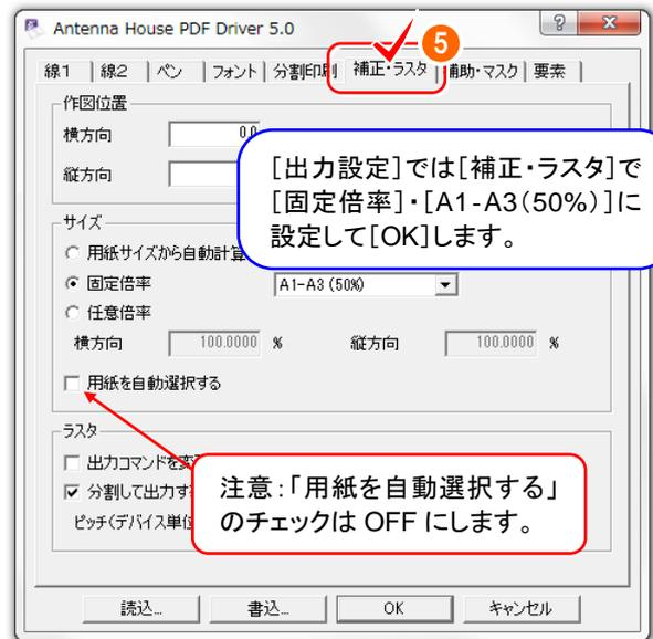
[出力設定]では[補正・ラスタ]で[固定倍率]・[A1-A3(50%)]に設定して[OK]します。
