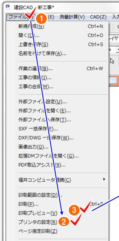
6 プレビュー表示を確認後、[印刷]をクリックして出力してください。
